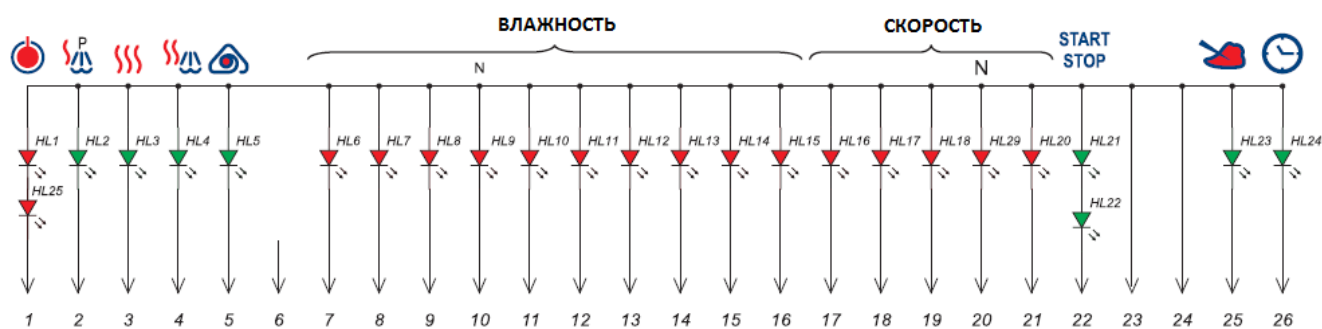
Схема электрическая соединения светодиодов
