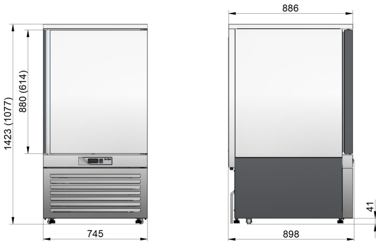
Рис. 2 Габаритные размеры шкафа ШОК-10-1/1 серия Light (в скобках – отличия шкафов ШОК-6-1/1 и ШОК-5-1/1 серии Light)
